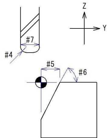
右下の XY 平面の図は、どこからどこまでテーパ加工を行うかという X 軸方向の開始座標 (#2) と終了座標 (#3) です。残るは加工速度 (#9) と X 方向のピッチ (#17)。そして図には入れませんでしたが Z 軸の逃げ位置 (#11) と、加工原点が別の位置にあった場合を考えて、Y 軸方向の位置 (#1) も変数にしておきます。
