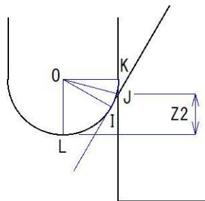
図を見るとわかりますが、工具  $R$  が入ると  $Z2$  の距離分、工具が下がることがわかります。従って  $Z2$  を求めればよいわけです。「 $Z2 = OL - KJ$ 」で求められ、 $OL$  は工具  $R$  ( $\#4$ ) と同じ、残りの  $KJ$  は「 $KJ = OK (\text{工具 } R) * \text{TAN}[\angle JOK]$ 」で求められるので、 $\angle JOK$  を求めていきます。
