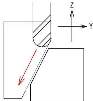
では、実際に右の図の座標を用いてプログラムを作ります。ワークの長さ合わせて X 軸の移動量を変更できるように、X 軸の開始座標と終了座標をそれぞれ #2 と #3 の変数にします。工具径補正值はあらかじめ「D1」に入れておくものとします（プログラム内でシステム変数を使って入力しても問題ありません）。
