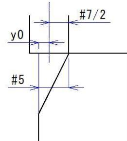
Z 軸の逃げ（#11）による Y 軸の変化量は、Y 軸の変化量を  $y_1$  とおくと  $\text{TAN}[\#6] = \#11 / y_1$  となるので、左辺が  $y_1$  となるように整理すると  $y_1 = \#11 / \text{TAN}[\#6]$  となります。
