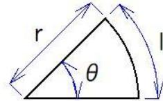
NC プログラムでは三角関数を使うときに弧度法は使えないのですが、度数法に変換する必要があります。本書では弧の長さから角度を算出する式が出てきますが、ラジアン ( $l/r$ ) に「 $180 / \pi$ 」をかけば度数法になりますので、角度  $\theta$  は「 $(180 \times l) / (\pi r)$ 」となります。
