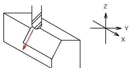
この工具軌道のテーパ加工は、工具径補正を使うと簡単に実現できますが、ちょっとした問題もあります。ここではまず、工具径補正を使った方法を紹介し、その後汎用性の高いプログラムの作り方を紹介します。
